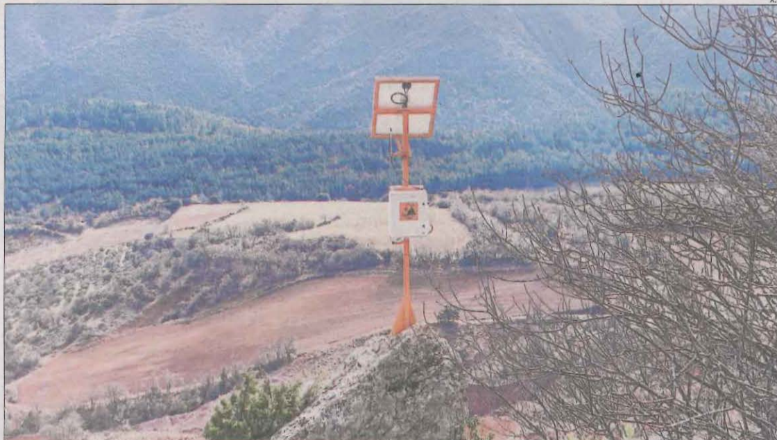
La torre que recull tota la informació dels sensors instal·lats al pendent.
